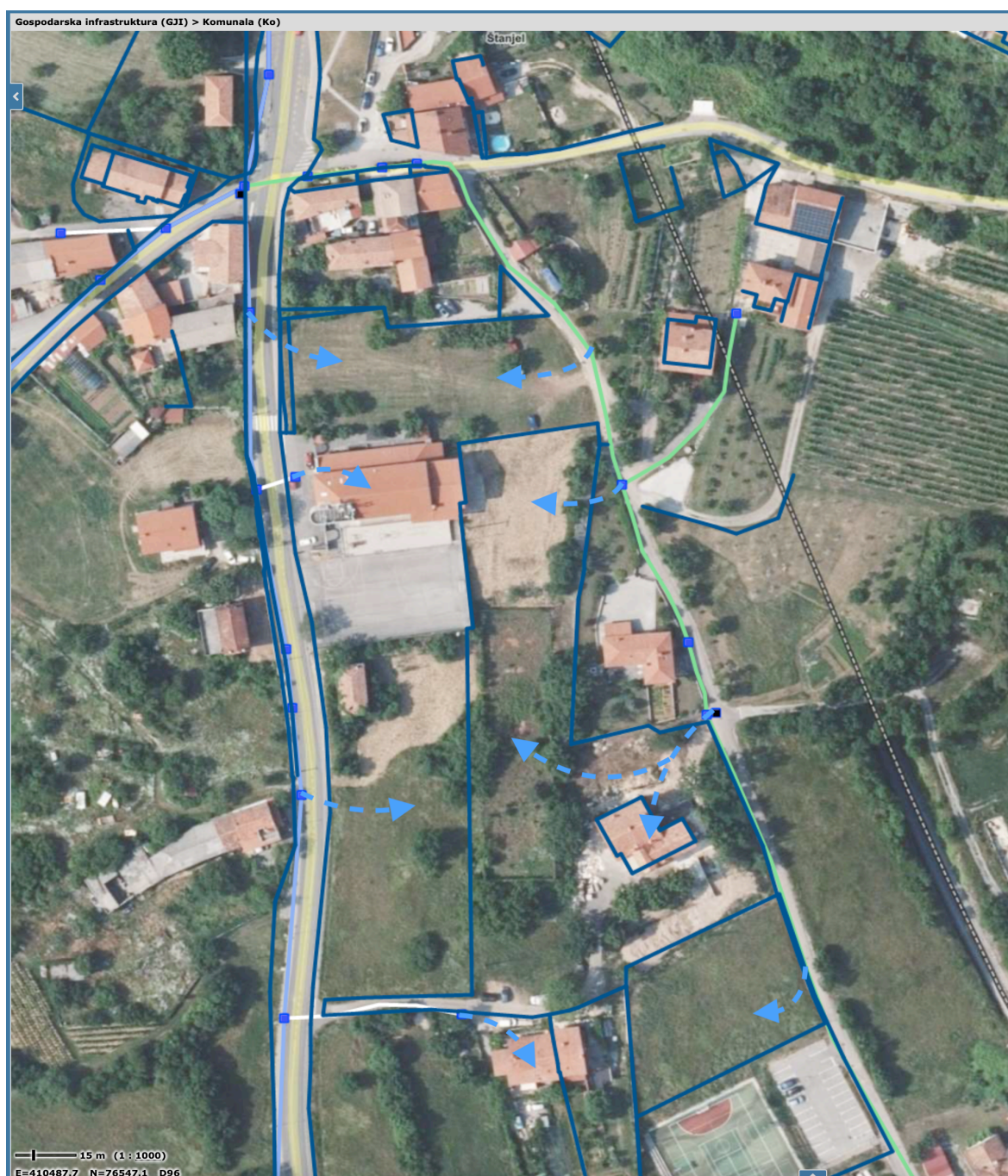
OBMOČJE OPPN ŠT-13 - OBSTOJEČE IN MOŽNE LOKACIJE PRIKLJUČITVE NA OBSTOJEČO VODOVODNO OMREŽJE
